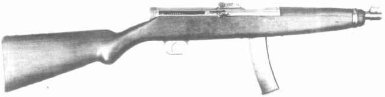
7,62-мм пистолет-пулемет системы Дегтярева, опытный образец 1931 г.
