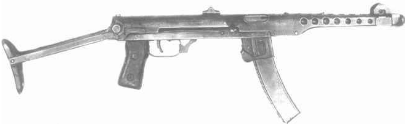
7,62-мм пистолет-пулемет системы Судаева образца 1943 г. ППС-43
