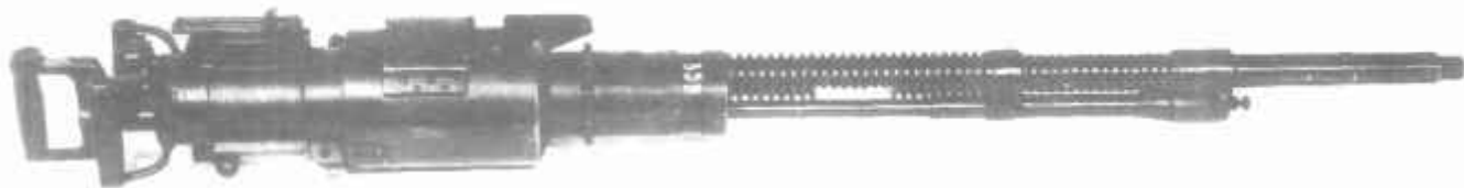
12,7-мм крупнокалиберный авиационный пулемет системы Шпитального-Владимирова ШВАК
