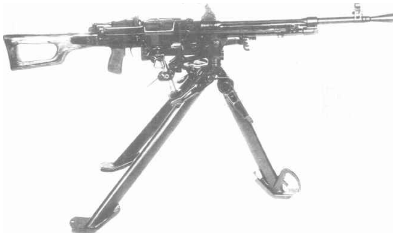
7,62-мм станковый пулемет системы Никитина-Соколова на станке Саможенкова, опытный образец
